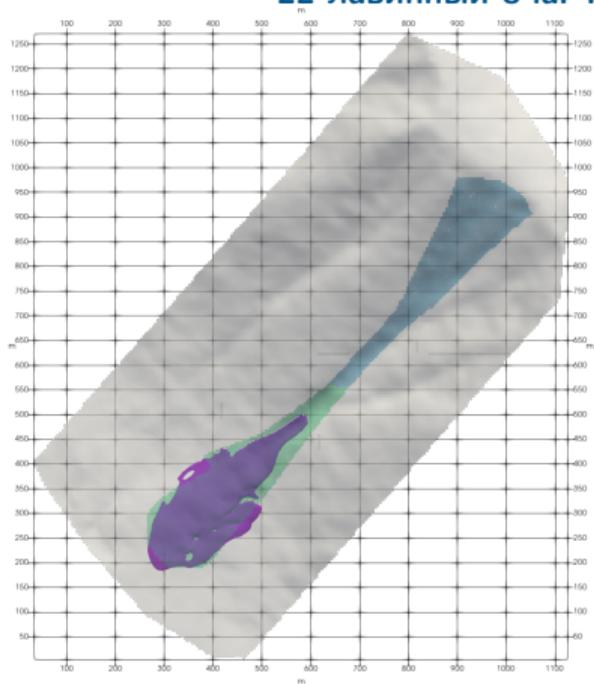
Расчёт с использованием  $k - \omega$  SST модели турбулентности с исходными коэффициентами
