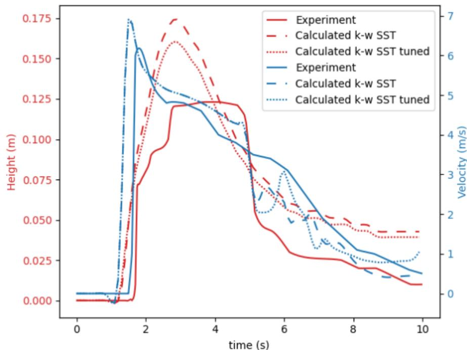
Графики скорости (синий) и глубины потока (красный), замеренные на расстоянии 11.1 метра от начала установки. Показаны экспериментальные значения (Experiment), вычисленные с использованием  $k - \omega$  SST модели турбулентности (Calculated  $k - \omega$  SST) с исходными коэффициентами и вычисленные с использованием  $k - \omega$  SST модели турбулентности (Calculated  $k - \omega$  SST tuned) с оптимизированными коэффициентами.
