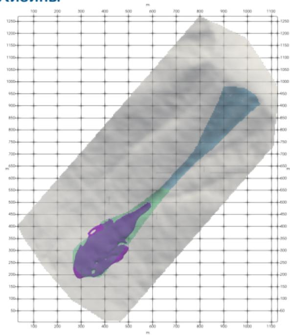
Расчёт с использованием  $k - \omega$  SST модели турбулентности с откалиброванными коэффициентами
