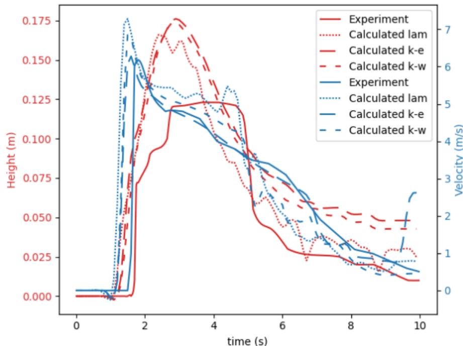
Графики скорости (синий) и глубины потока (красный), измеренные на расстоянии 11.1 метра от начала установки. Показаны экспериментальные значения (Experiment), вычисленные при ламинарном режиме течения (Calculated lam), вычисленные с использованием  $k-\varepsilon$  модели турбулентности (Calculated k-e) и вычисленные с использованием  $k-\omega$  SST модели турбулентности (Calculated k-w).
